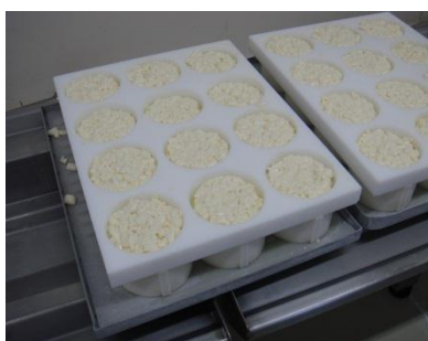
Photo 8 : Egouttage en moules
